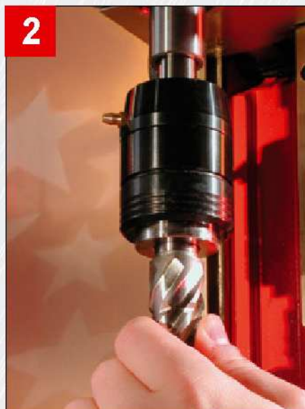
Rys. 2: Włożyć wiertło koronowe EasyLock. Zostaje ono zablokowane z wyraźnym odgłosem „klik”. Pierścień zabezpieczający zaskakuje do dołu.
