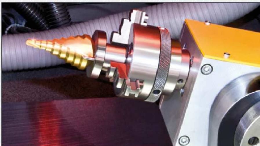
5. Ostrze wiertła szlifowane w technologii CBN, szlif krzyżowy wg DIN 1412 C
